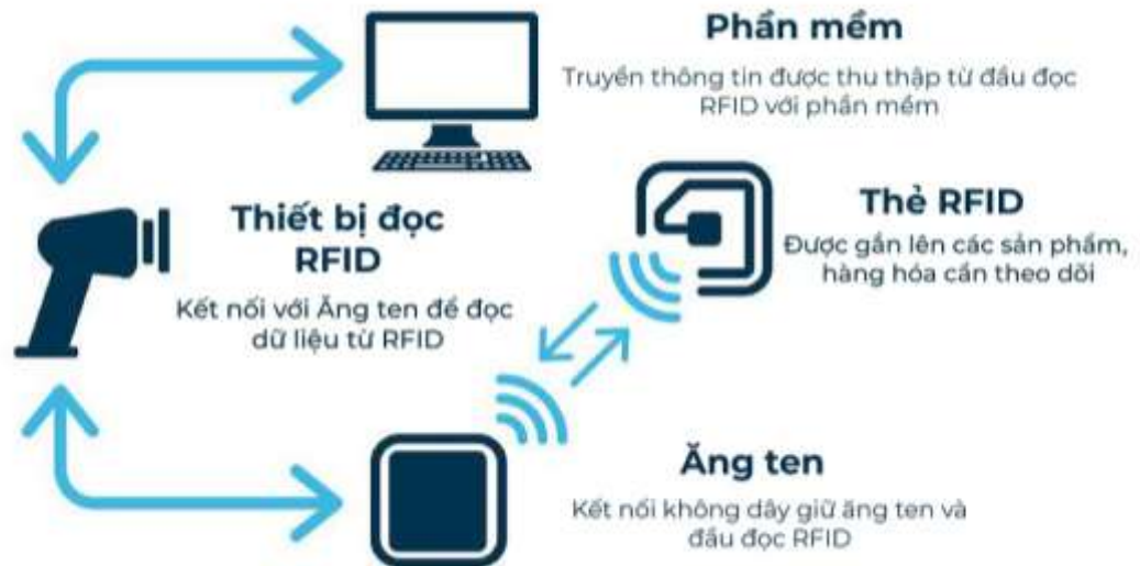
Hình 2.1. Thành phần và cách thức hoạt động của RFID
