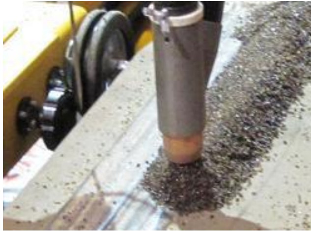
Hình 2.2: Hàn hồ quang dưới lớp thuốc
