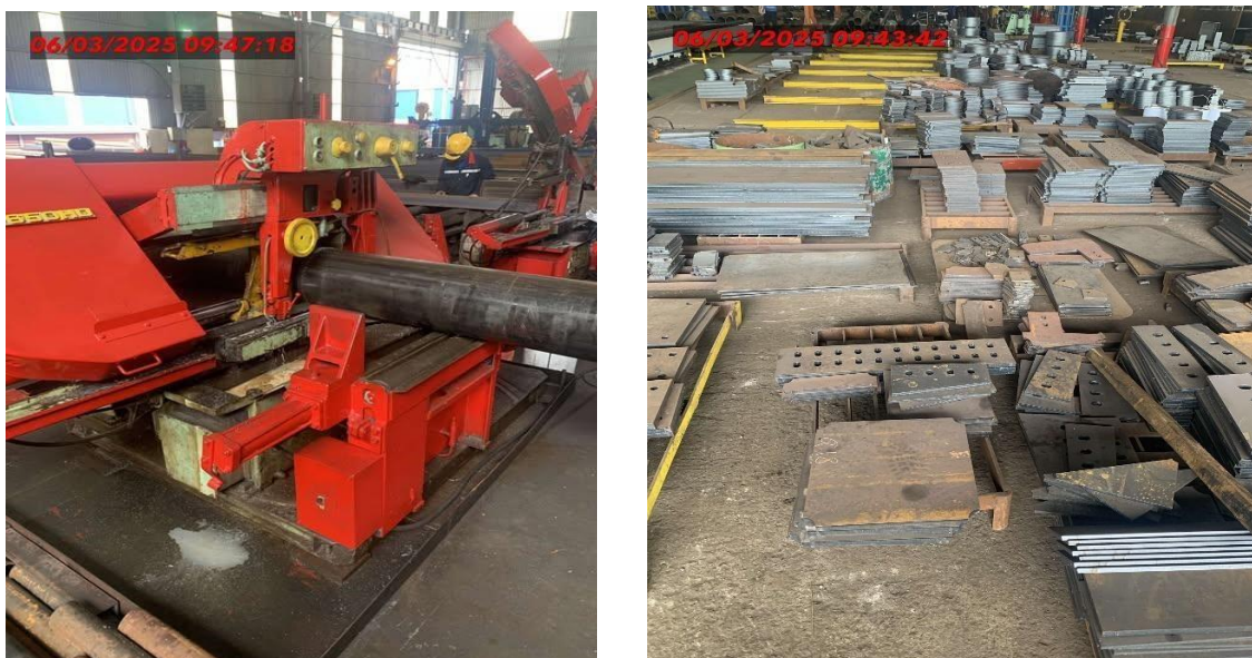
Hình 4.2: Cắt thép ra phôi
