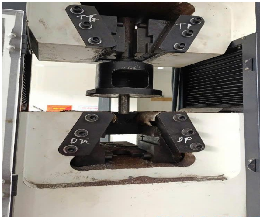
Hình 5.2: Phương pháp thử kéo vật tư
