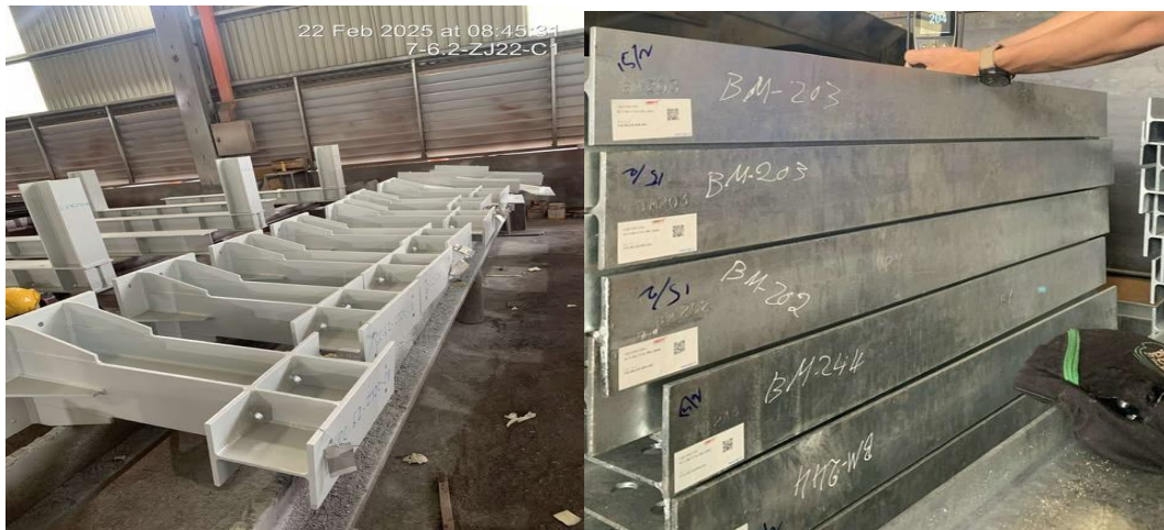
Hình 4.5: Sản phẩm được sơn – mạ kẽm
