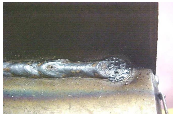
Hình 4.14: Mối hàn bị khuyết tật hình dạng
