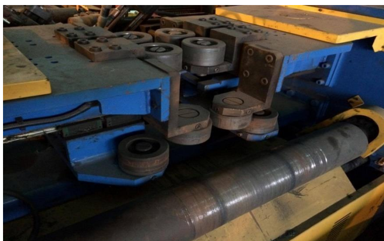
Hình 4.3: Bộ phận gá phôi của máy hàn dầm
