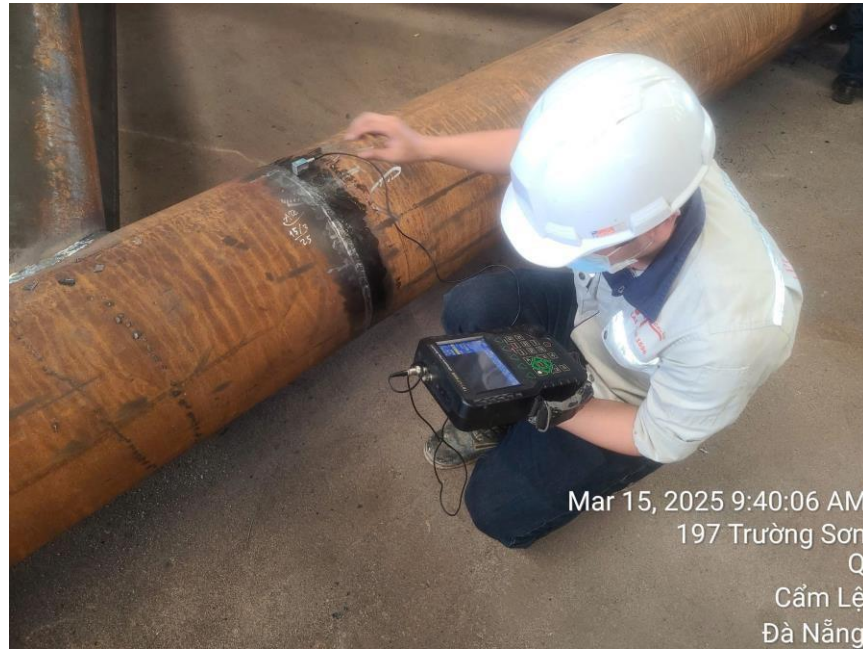
Hình 4.6: Kiểm tra siêu âm UT
