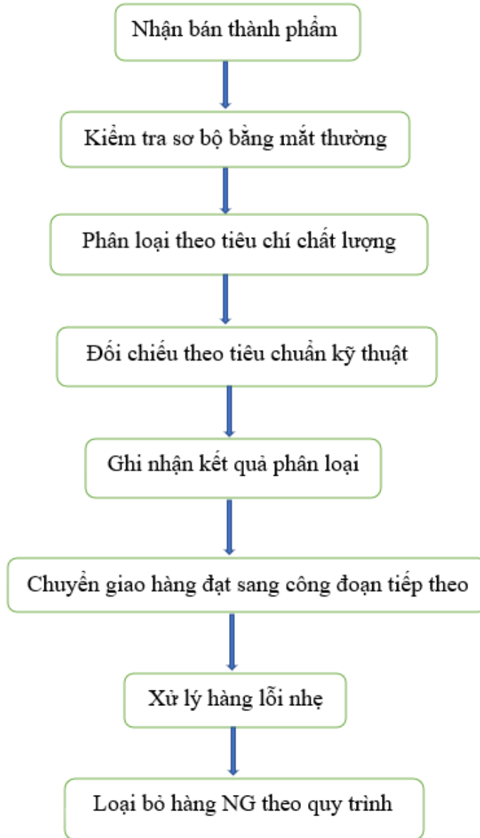
Hình 4. 5 Trình tự các bước tiêu chuẩn trong công đoạn Phân loại các bán thành phẩm
