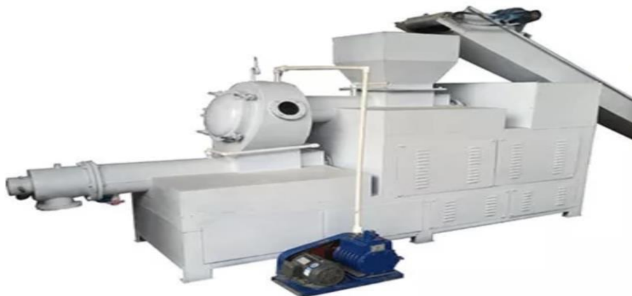
Hình 2.8: Máy đùn ép - xà phòng
