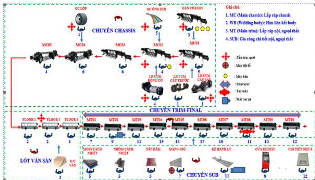
Hình 2.3. Layout bố trí khu vực sản xuất xe bus B60
