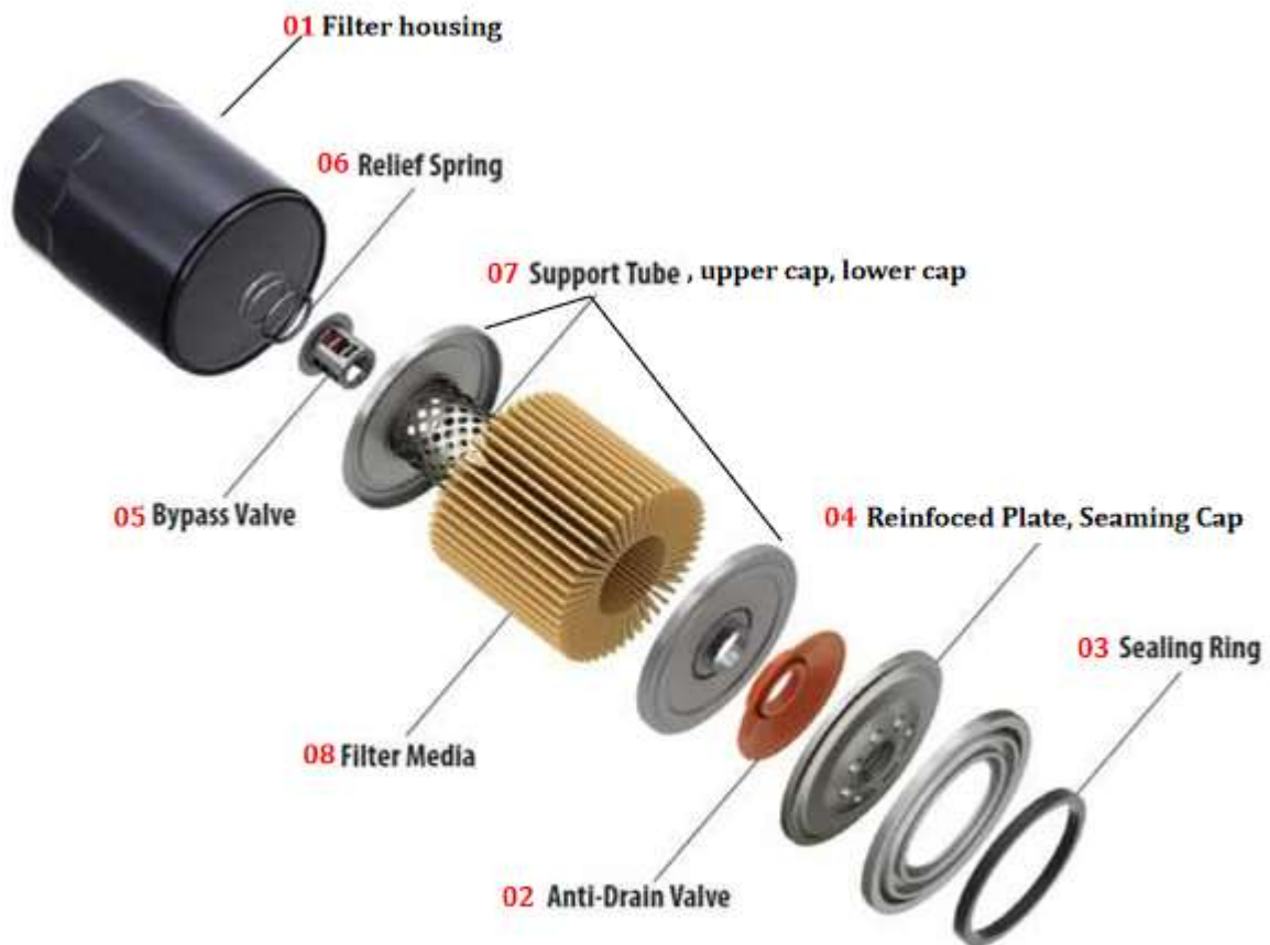
Hình 3.4 Cấu tạo của bộ lọc dầu Spin-on
