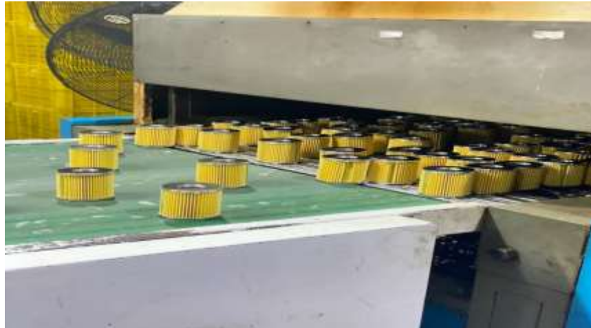
Hình 4.5 Lõi lọc di chuyển lộn xộn vào máy sấy
