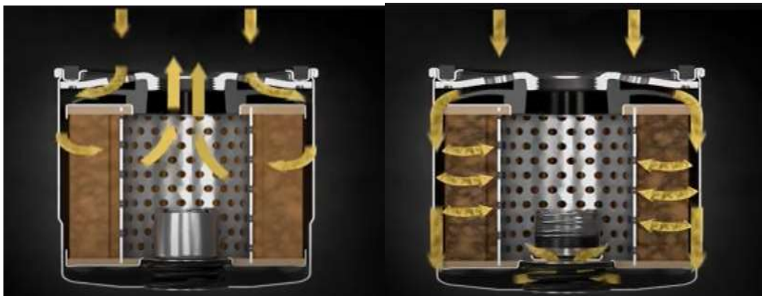
Hình 3.6 Lưu lượng dầu chuẩn qua bộ lọc và dòng chảy khẩn cấp khi lõi lọc bị tắc nghẽn
