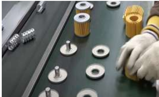
Hình 3.8 Lắp ráp linh kiện để tạo thành lõi lọc
