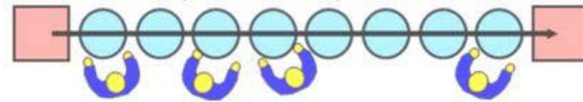
Hình 2.9 Sơ đồ dây chuyền sản xuất bố trí theo đường thẳng
