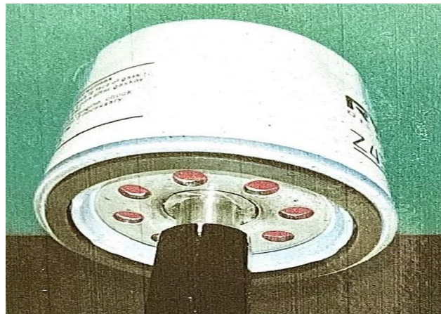
Hình 5.6: Quay ren vào lút hết lỗ ren, nắp ren đảm bảo về độ vuông góc, kín khít khi lắp ráp vào động cơ
