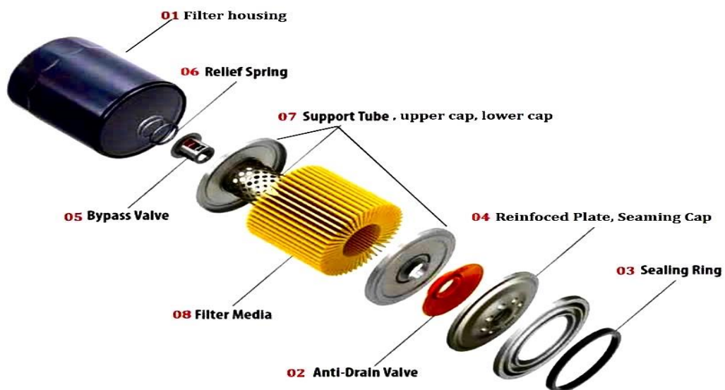
Hình 3.5: Cấu tạo của bộ lọc dầu Spin-on
