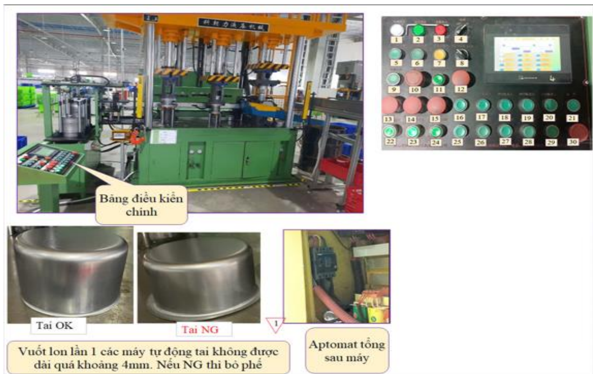
Hình 5.1: Bảng điều khiển trên máy vuốt vỏ lon
