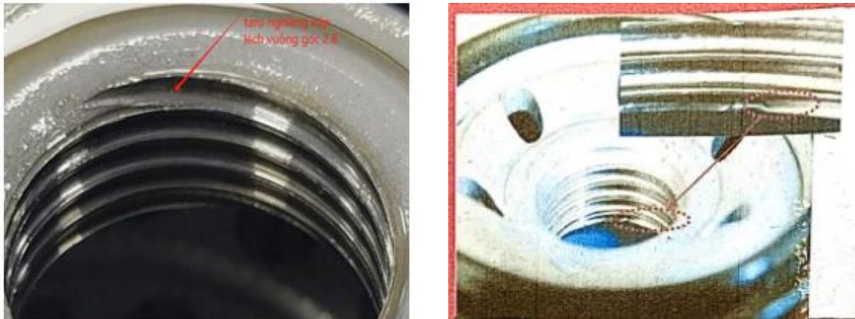
Hình 4.4: Lỗi đường ren taro nghiêng và lỗi mẻ đường ren cuối
