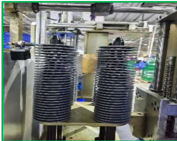
Hình 5.5: Trụ chứa nắp sau khi được thiết kế lại, các nắp ren được xếp đều, thẳng đứng và không còn tình trạng nghiêng lệch, xiêng vẹo
