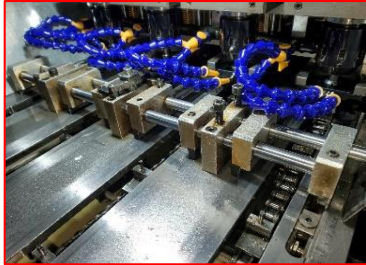
Hình 4.8: Thanh dẫn nắp đầu vào lâu ngày bị biến dạng hờ rộng ra
