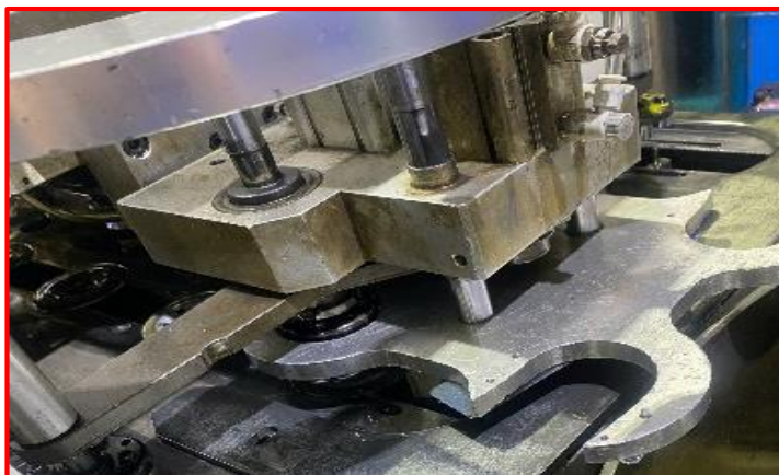
Hình 4.12: Bộ gấp nắp ren bị rơi lắt
