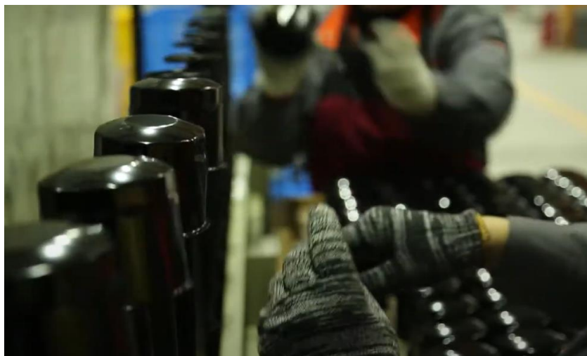
Hình 5.14: Công nhân đeo găng tay trong quá trình lấy vỏ lon ra khỏi buồng sơn
