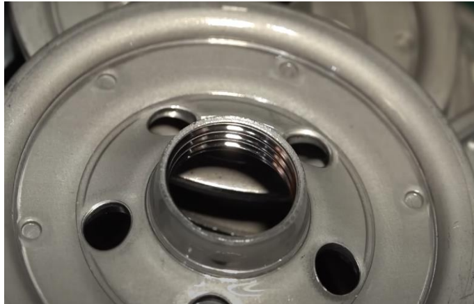
Hình 5.13: Đường ren trên nắp hoàn chỉnh, không xảy ra tình trạng mé đường ren cuối
