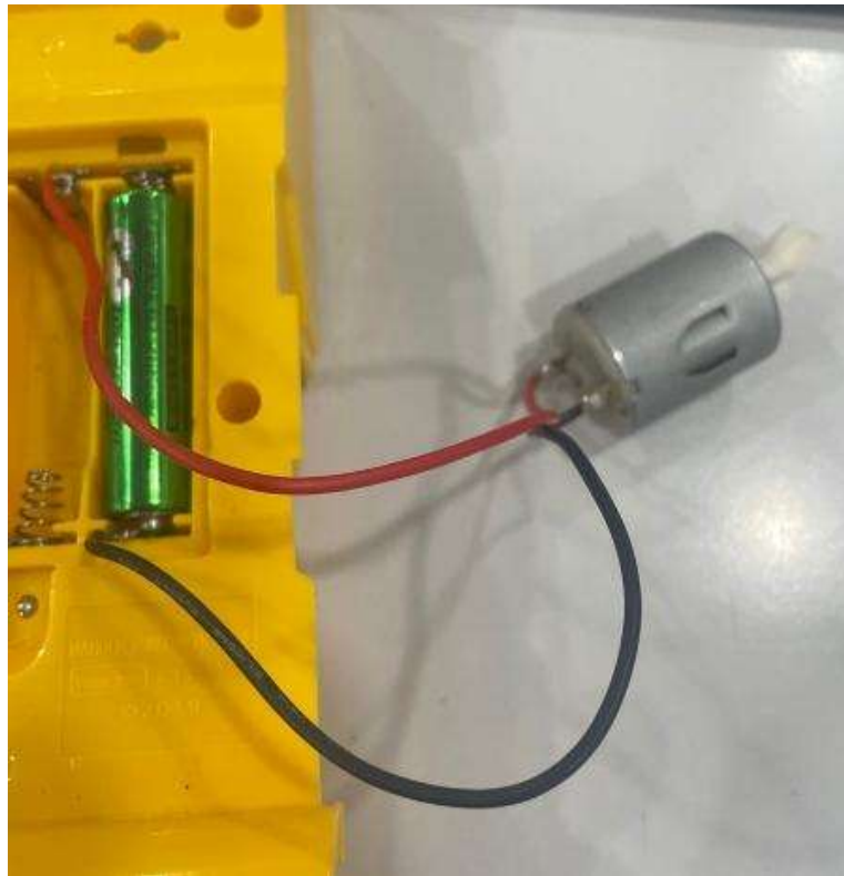
Hình 4.6 Pin nối trực tiếp motor để tiến hành thí nghiệm 3a)
