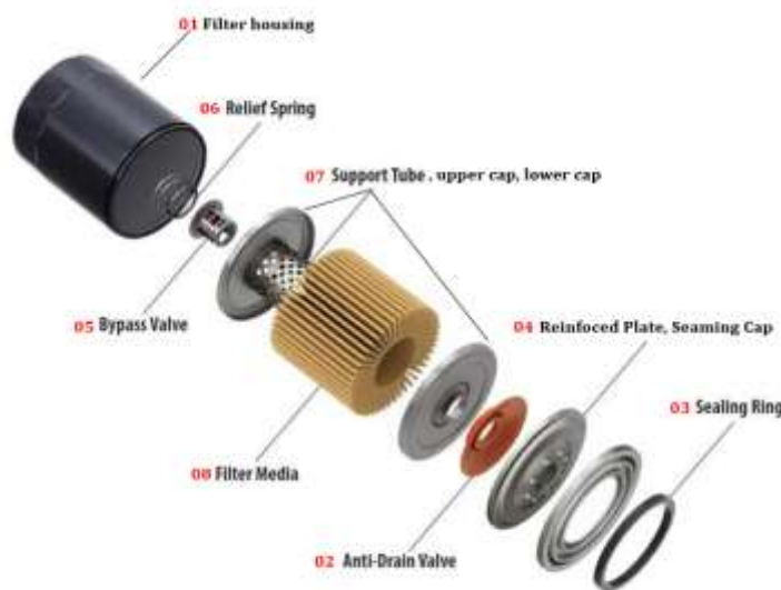
Hình 3.7: Cấu tạo của bộ lọc dầu
