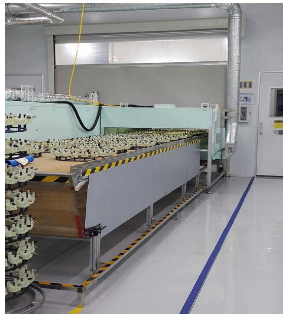
Hình 10: Mô hình băng chuyền sấy tự động kết hợp robot sơn
