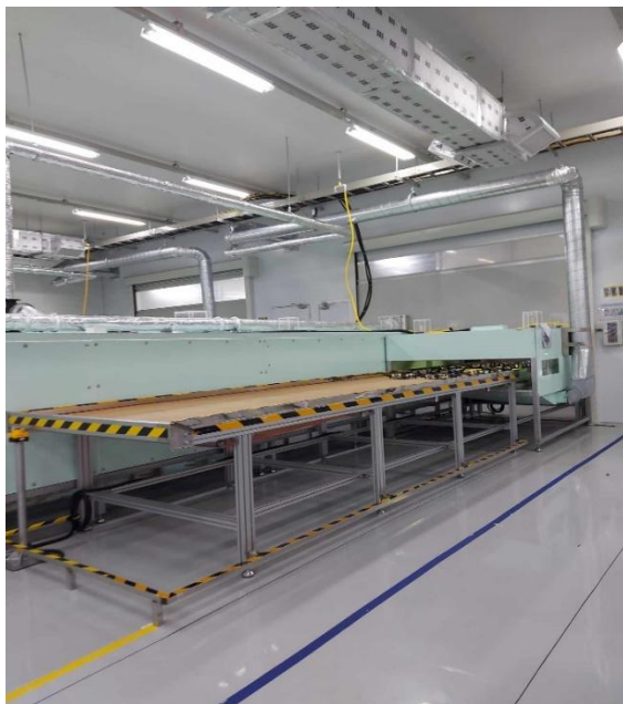
Hình 10: Mô hình băng chuyền sấy tự động kết hợp robot sơn
