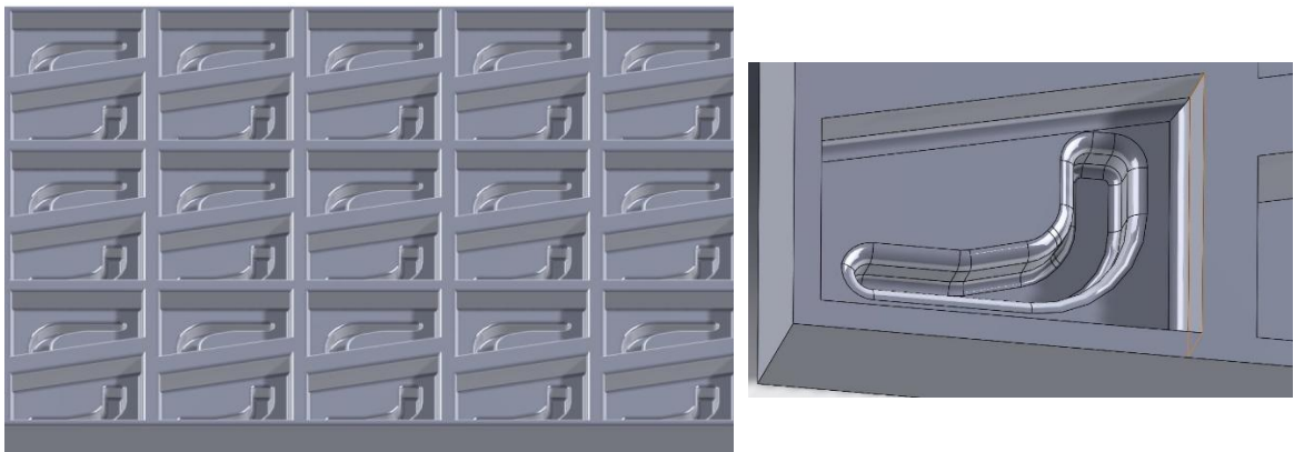
Hình 21: Mẫu vỉ đựng handle sau cải tiến
