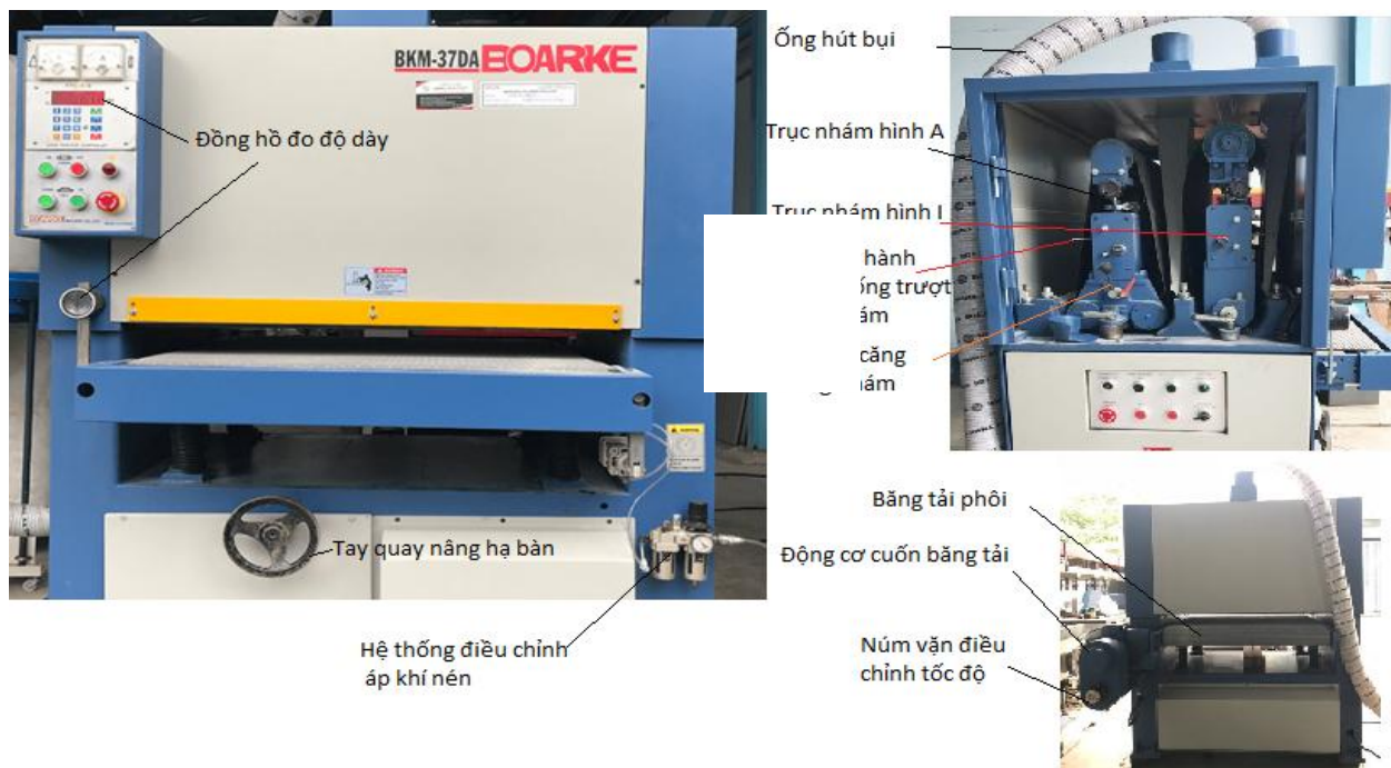
Hình 5.2: Cấu tạo của máy nhám thùng
