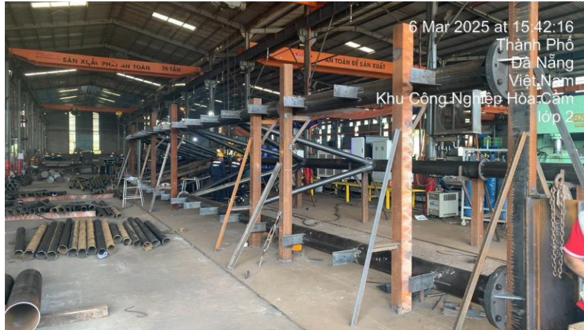
Hình 3.10: Lắp, ghép các chi tiết thành cấu kiện
