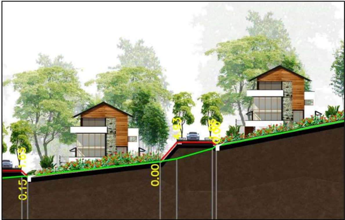
Hình 2. 1: Hình ảnh minh họa giải pháp san nền cục bộ và xử lý chênh cao
