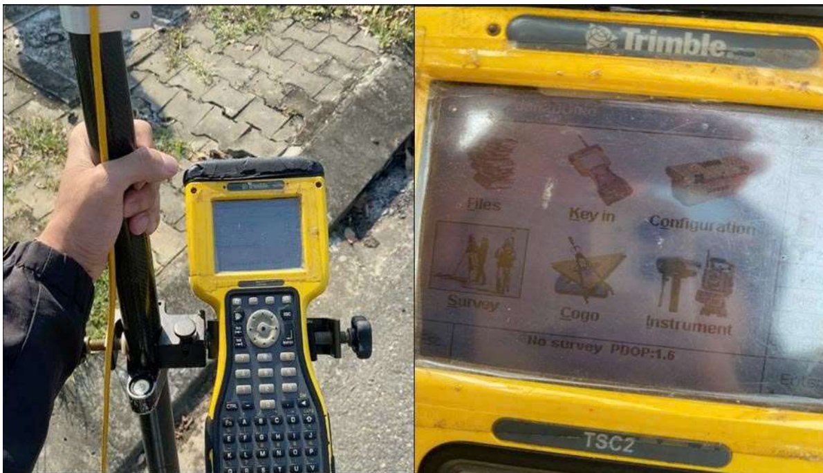
Hình 2.5: Thiết lập máy đo RTK
