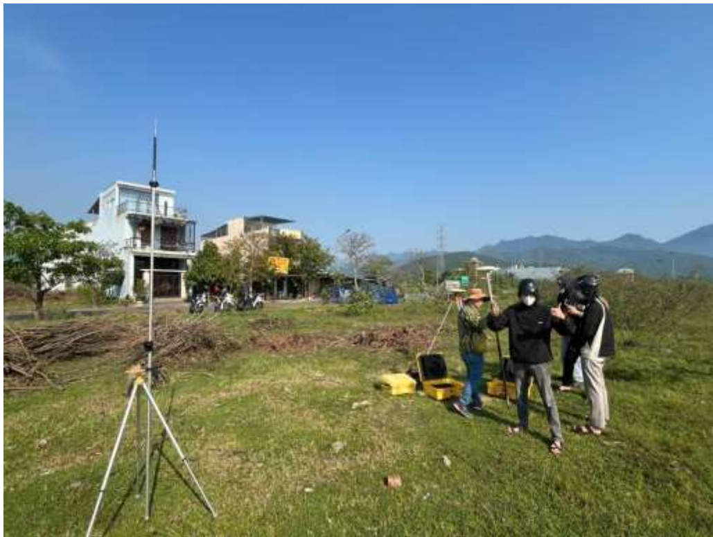
Hình 2.2: Chuẩn bị thiết bị đo đạc GNSS Trimble R5 ở thực địa
