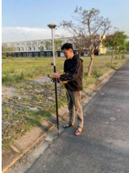
Hình 2.6: Tiến hành đo cao độ hiện trạng bằng máy GPS Trimble R5
