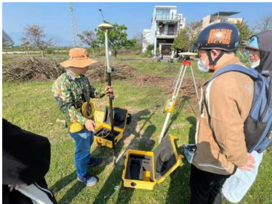
Hình 2.4: Lắp đặt thiết bị Rover và kiểm tra thông số kỹ thuật trước khi đo đạc
