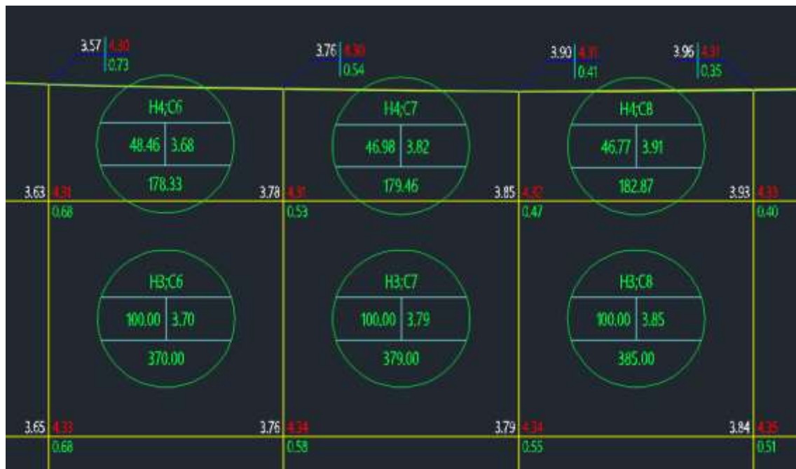
Hình 2.13: Bản đồ san nền thiết kế – thực hiện bằng phần mềm NXSOFT
