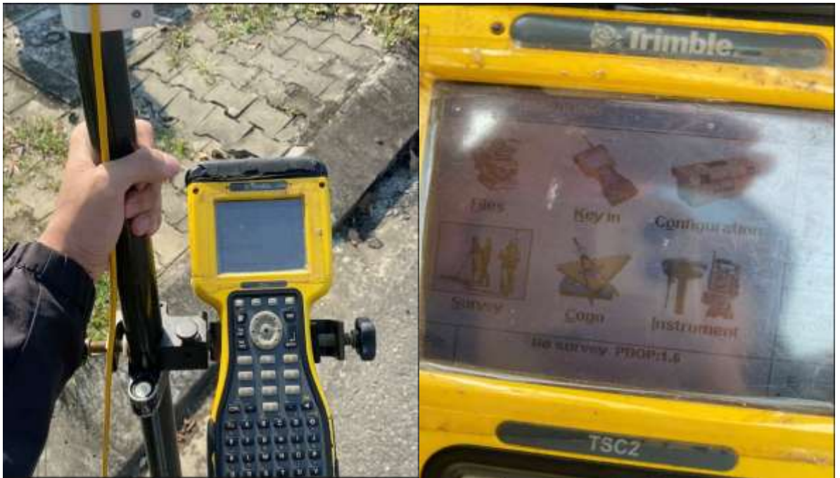
Hình 2.3: Thiết lập máy đo RTK
