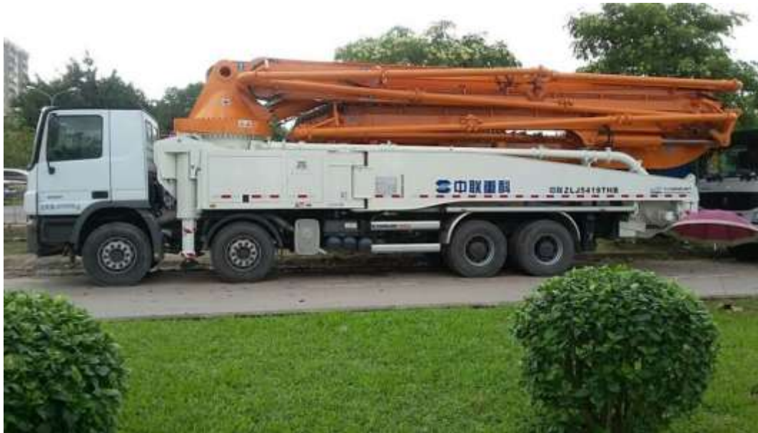
Hình 2.29: Xe bơm bê tông Zoomlion Cifa cần 52m
