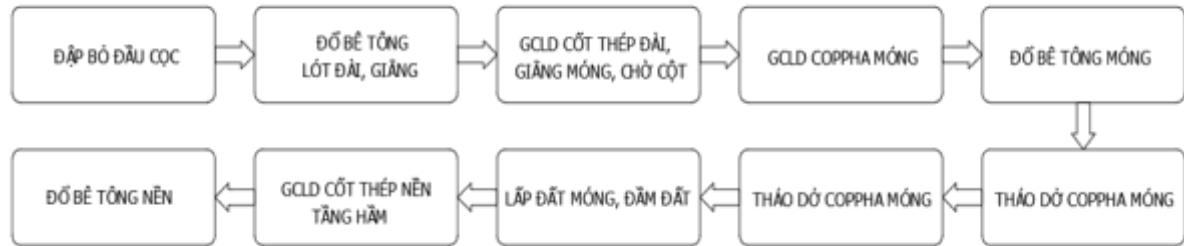
Hình 2.30: Sơ đồ dây chuyền thi công móng
