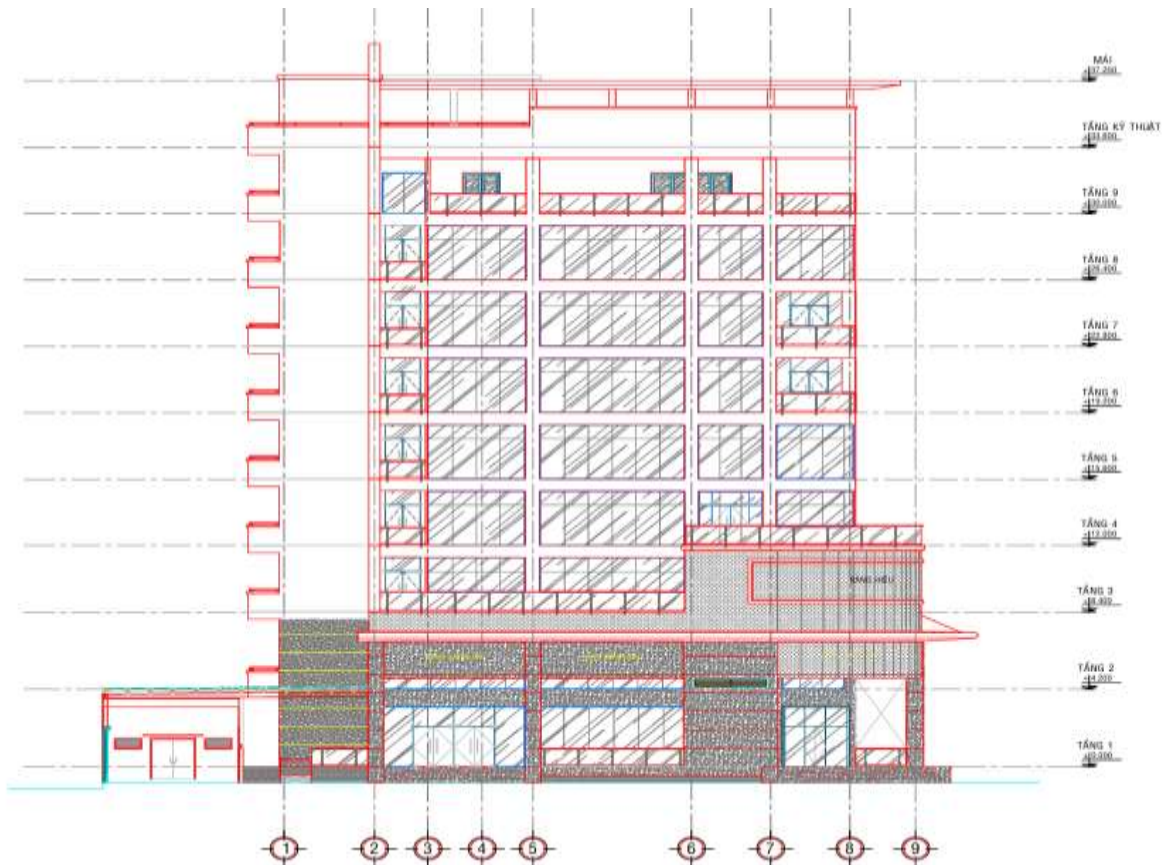
Hình 1.3 Giải pháp mặt đứng công trình (trục 1-9)
