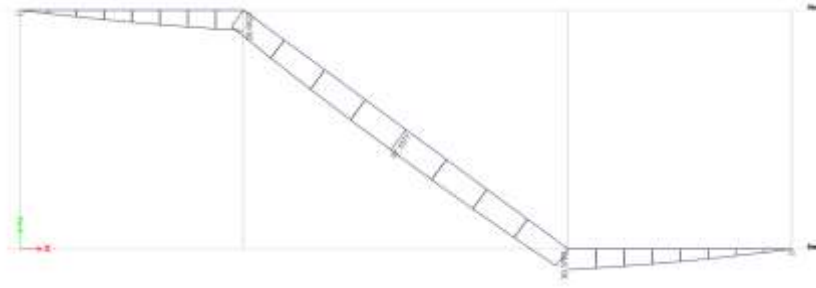
Hình 4.10: Biểu đồ mômen dầm chiếu nghỉ cầu thang
