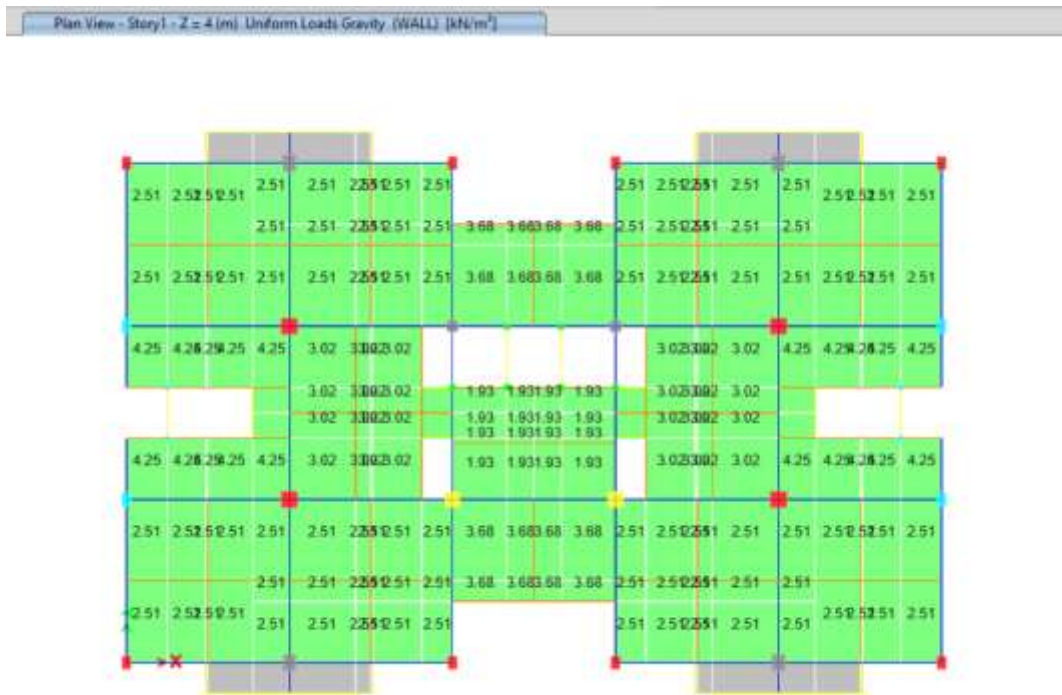
Hình 3.7. Tải trọng tường tác dụng lên ô sàn tầng điển hình.
