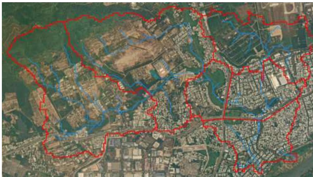
Hình 2. 2: Sử dụng mô hình ArcGis để chia lưu vực và nhánh sông
