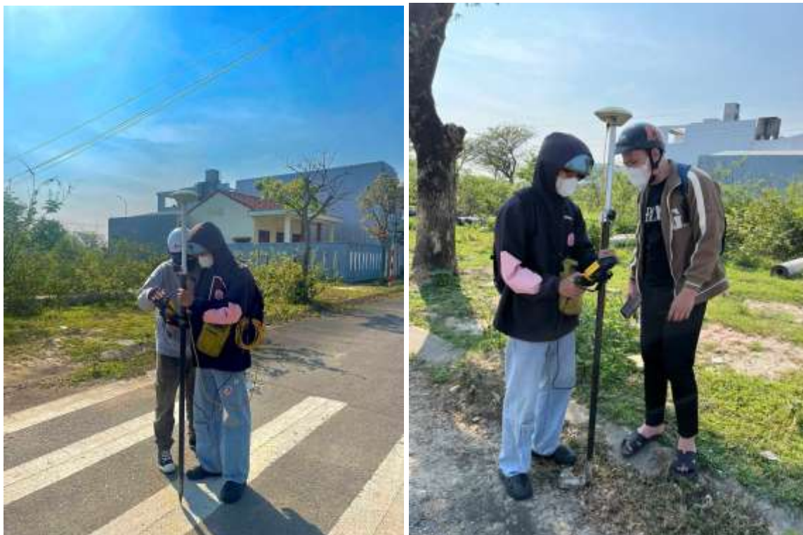
Hình 2.4: Tiến hành đo cao độ hiện trạng bằng máy GPS Trimble R5
