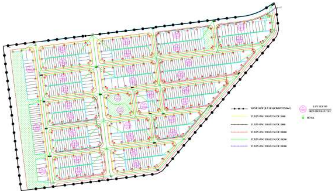
Hình 4.2: Sơ đồ vạch tuyến thoát nước mưa
