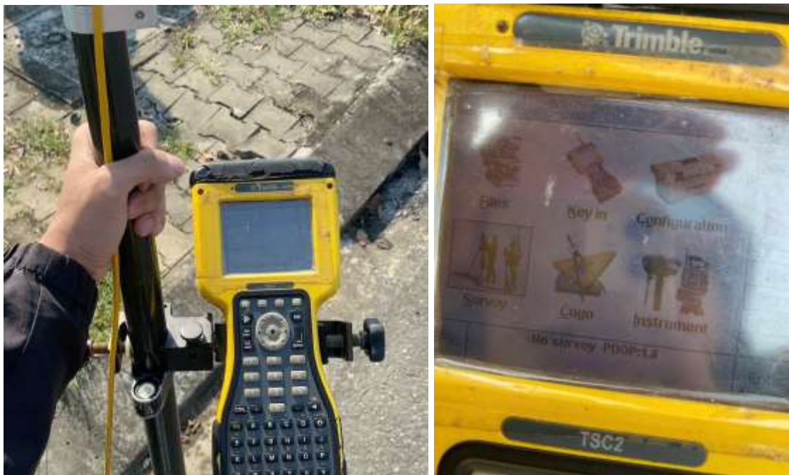
Hình 2.3: Thiết lập máy đo RTK
