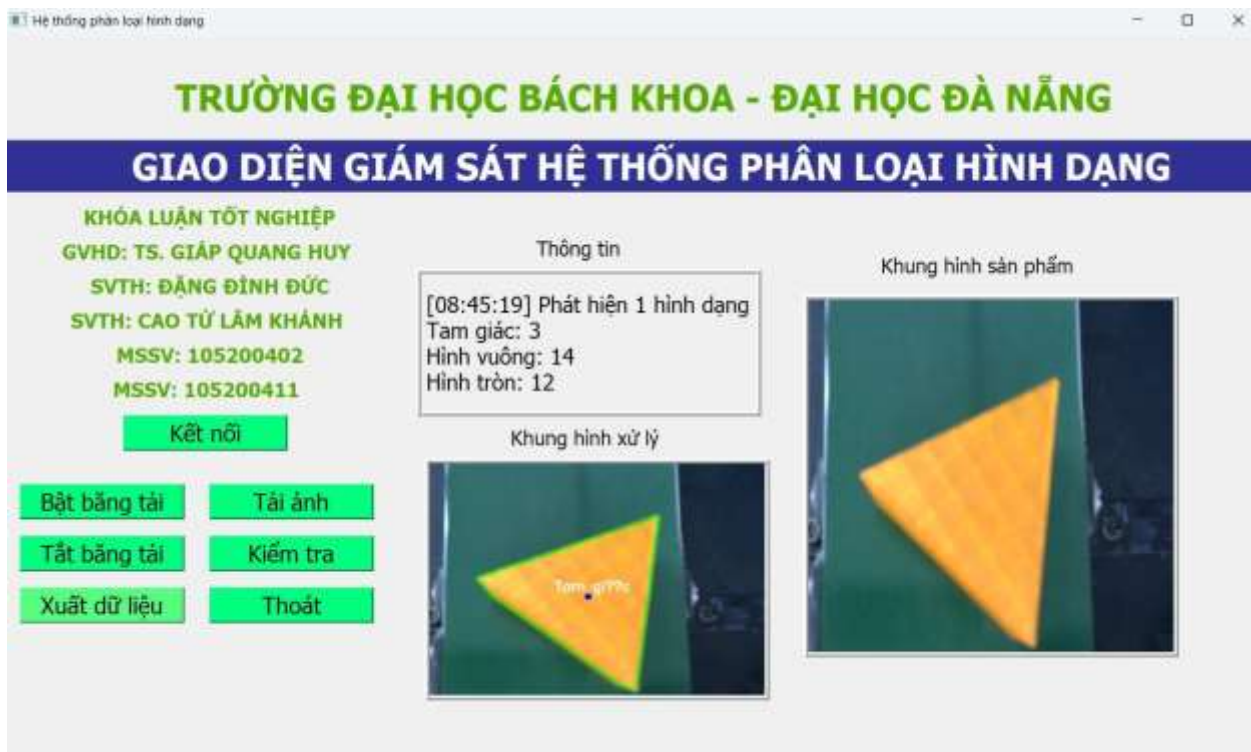
Hình 5.3 Camera nhận diện được hình tam giác
