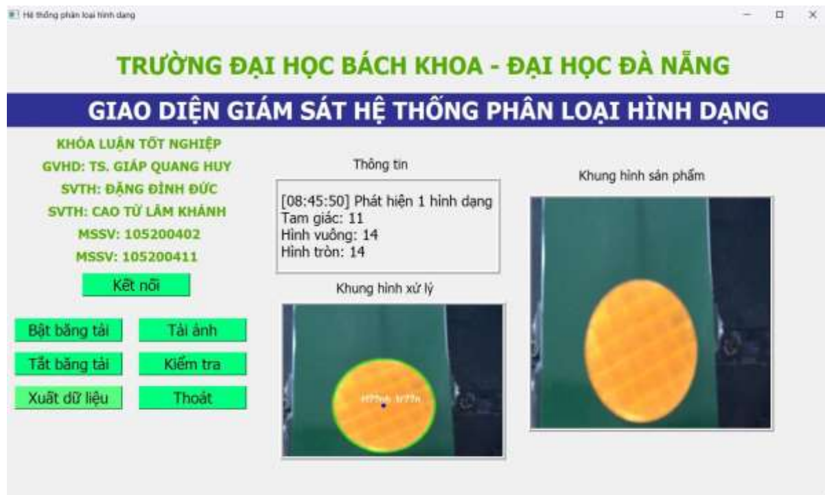
Hình 5.2 Camera nhận diện được hình tròn
