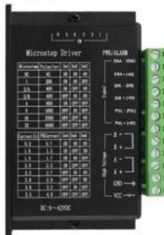
Hình 2.18 Driver điều khiển động cơ bước TB6600
