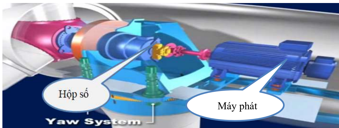
Hình 1.14: Hộp số và máy phát điện.
