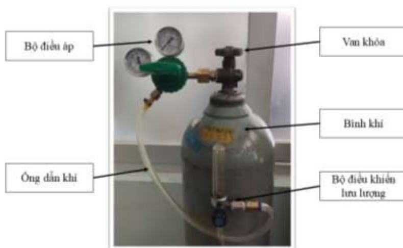
Hình 2.21: Hình ảnh sơ đồ bình khí nén khí Nitơ
