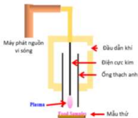
Hình 1.18: Sơ đồ tạo plasma bằng nguồn vi sóng
