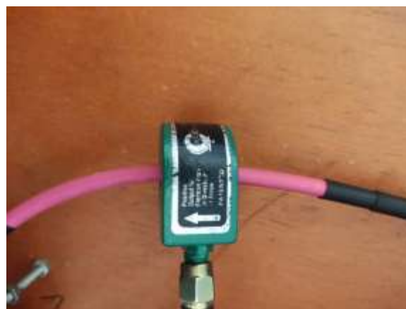
Hình 2.13: Kích thước máy biến dòng điện Hình 2.14: Hình ảnh máy biến dòng điện
