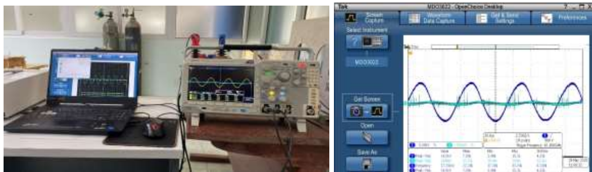
Hình 2.18: Kết nối Oscilloscope với máy tính
