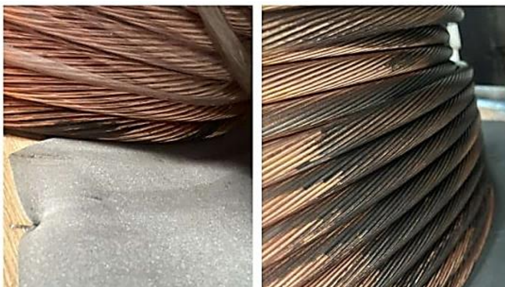
Hình 5-4 Dây đồng trần bị oxy hóa
