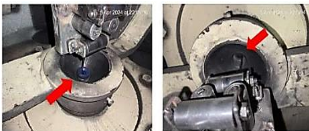
Hình 5-5 Mắt sứ bị bể trên máy Cigar
