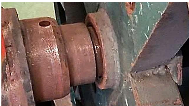
Hình 5-3 Côn dãn xả không khớp bobbin
