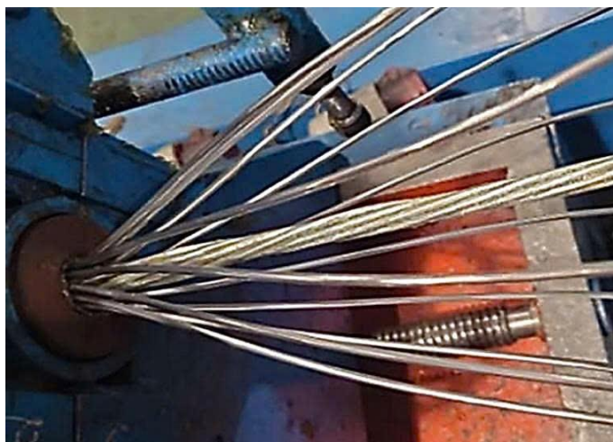
Hình 5-6 Lỗi thép bị bung, rối khi xoắn
