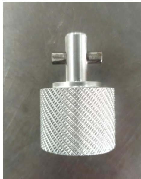
Hình 5.42: Đồ gá khuấy sơn mới sau khi gia công
