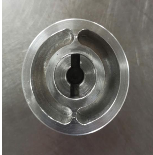
Hình 5.39: Kết hợp cơ cấu tháo lắp nhanh và đồ gá sau khi gia công
