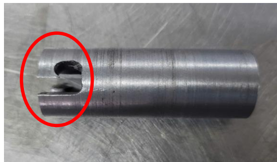
Hình 5.38: Cơ cấu tháo lắp nhanh sau khi gia công
