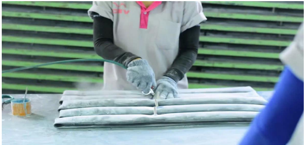
Hình 3.10: Bơm hơi sau khi nối xong đầu nối
