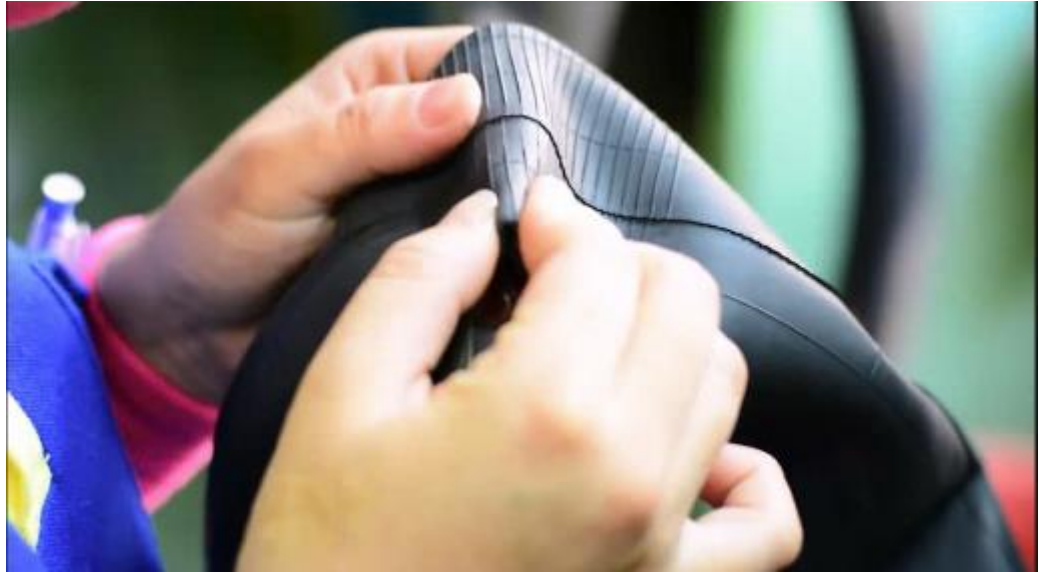
Hình 3.11: QC kiểm tra đầu nối sẫm
