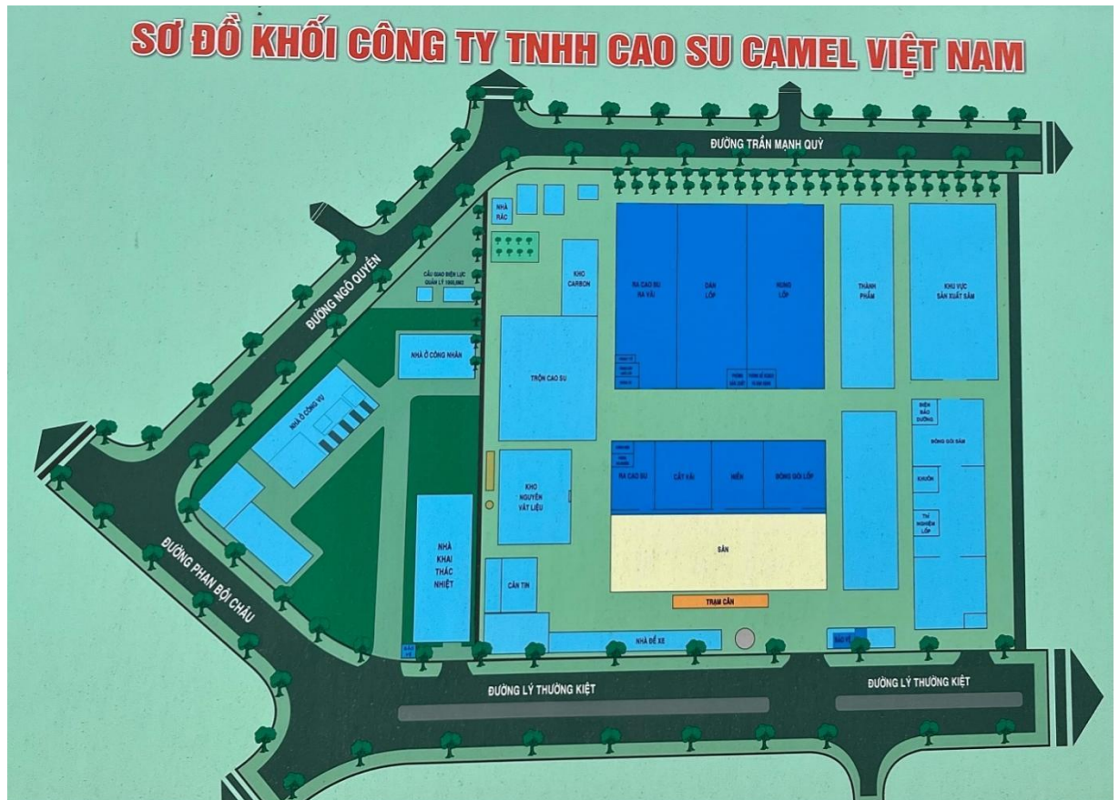
Hình 3.5: Mặt bằng sản xuất nhà máy
