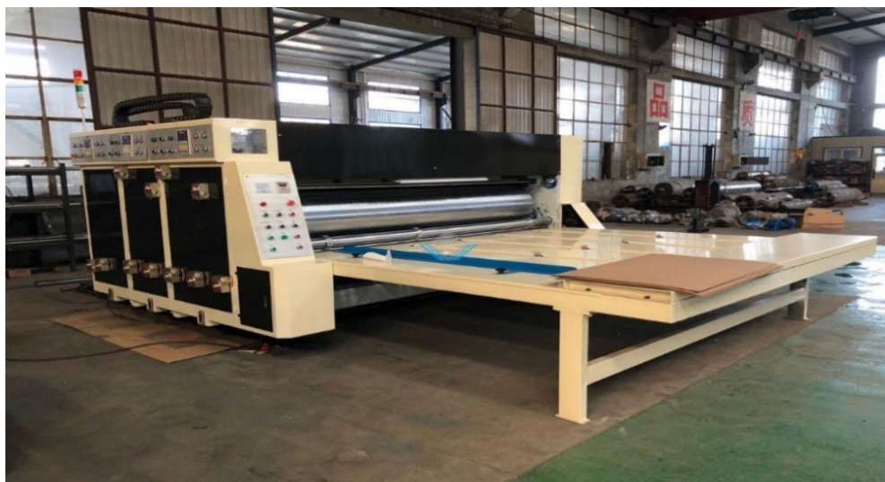
Hình 3.2: Phôi được đưa vào máy in flexo.
