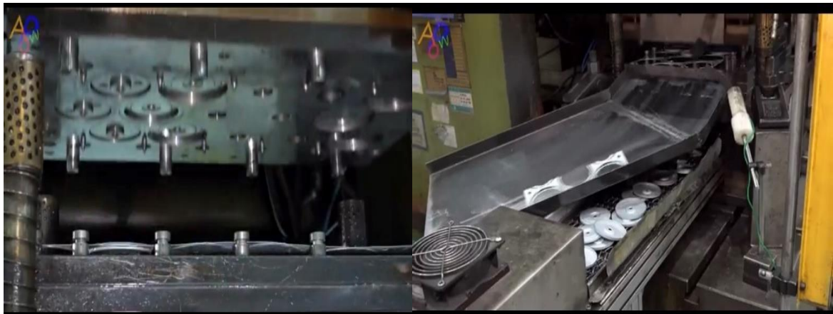
Hình 3.8: Hình ảnh công đoạn tạo nắp trên/ nắp dưới
