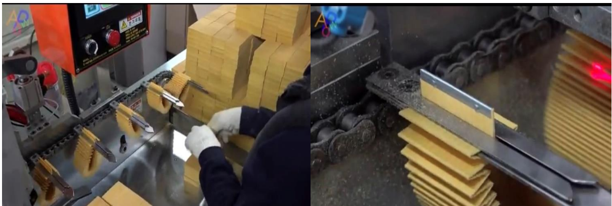
Hình 3.12: Hình ảnh công đoạn kẹp mí
