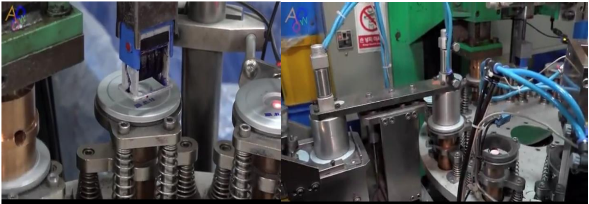
Hình 3.9: Hình ảnh công đoạn hàn van
