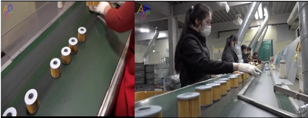
Hình 3.13: Hình ảnh công đoạn lắp ráp lõi lọc
