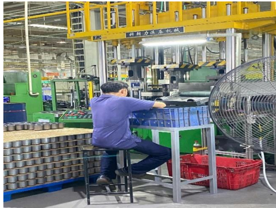
Hình 3.15 Công đoạn vuốt lon
