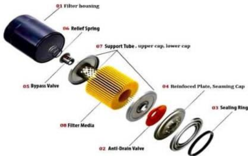
Hình 3.6 Sơ đồ cấu tạo bộ lọc dầu Spin-on
