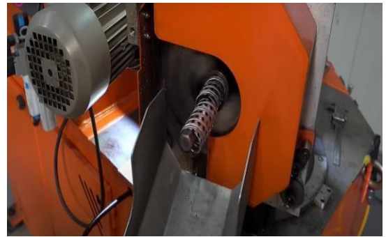
Hình 3.13 Công đoạn cuộn ống trung tâm
