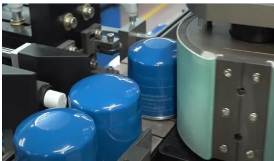
Hình 3.23 Công đoạn in nhãn
