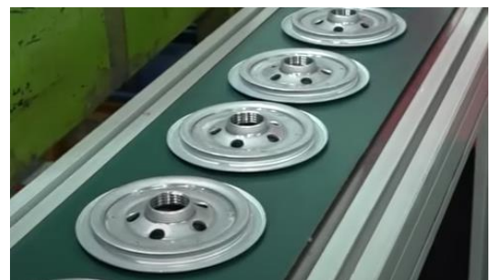
Hình 3.11 Công đoạn dập/ tán nắp ren và nắp viền
