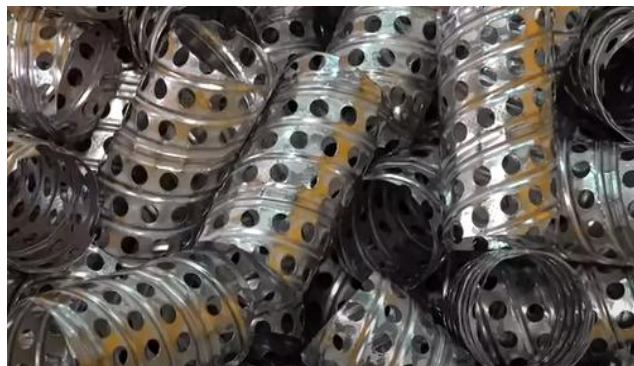
Hình 3.14 Ống trung tâm gia công hoàn thiện
