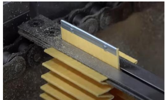
Hình 3.19 Công đoạn kẹp mí
