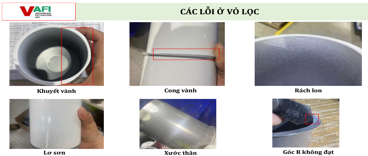
Hình 4. 4: Các lỗi thường gặp công đoạn hoàn thiện
