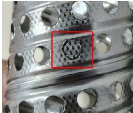
Hình 4.3: Lỗi thoát dầu đột không đứt
